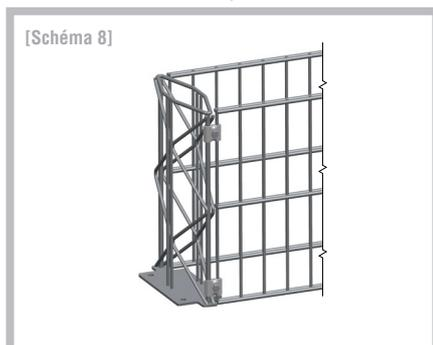
Vissez les nattes de grillage aux colonnes. Les nattes de grillage doivent arriver au niveau du sol. Elles doivent être fixées à l'aide de pinces de serrage universelles [Schéma 3], à répartir en-haut et en bas de façon uniforme (les serrer à la main).
